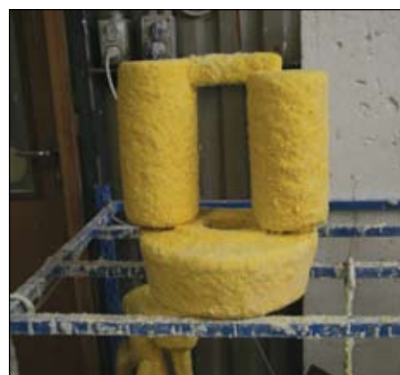
Støbeformen til Manx cylinderen klar til støbning.
