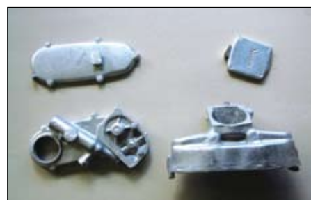
Rå dele af støbegods til cylinder, topstykke med videre, til den danske Manx.
