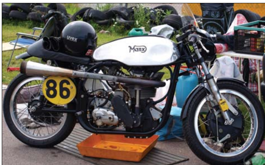
Nr. 86 er en dansk bygget Norton Manx, motordelene er støbt på Fyn hos Jørn Svendsen og delene er bearbejdet af Peter Dam på Sydals.
