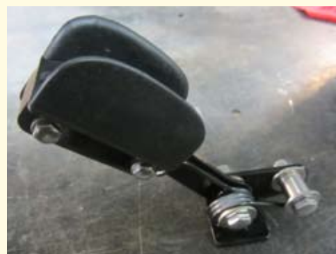
Her er så min ”Indian-version” monteret på et stykke vinkelstål, som boltes oven på kickstarterpedal-stoppet.
