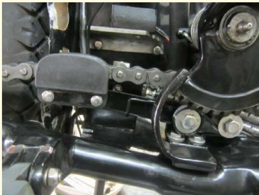
Her er så min ”Indian-version” monteret på et stykke vinkelstål, som boltes oven på kickstarterpedal-stoppet.
