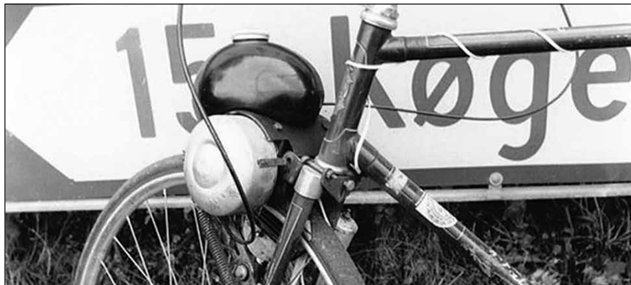
Standard herrecykel, grøn, WALDORFF" påmonteret TIKI-motor? Eet bremsesystem i navbremse. Lys fra dynamolygte foran og bagpå. Parkeret og sikret med kabellås på Køgevej i Haarlev i 1976. Godkendt med Rådet for større Færdselssikkerheds godkendelsesmærke. Ejeren ukendt. Foto: John Adamsen Jensen
